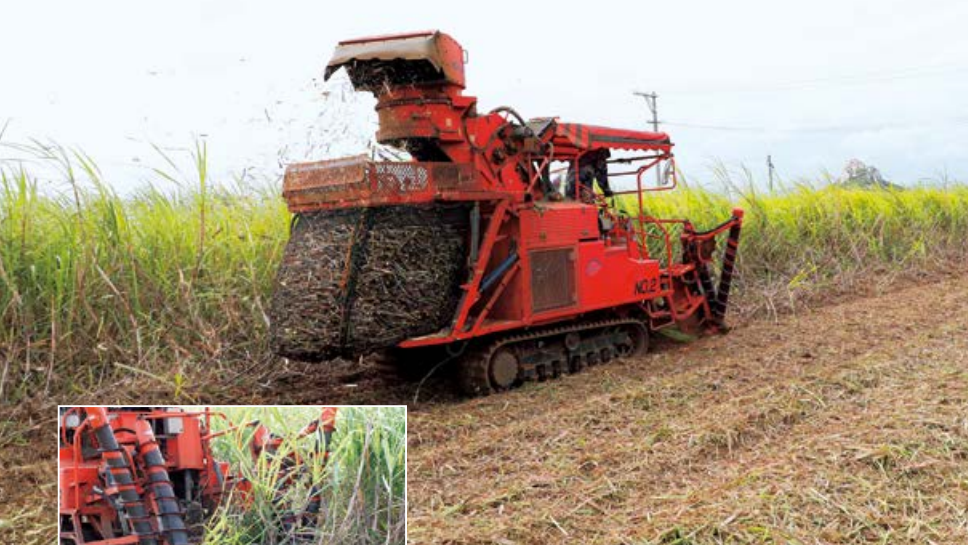
収穫機前方のローラーでさとうきびを巻き取り、葉と根がカットされて30~40cmに断裁後、ネットに収納
