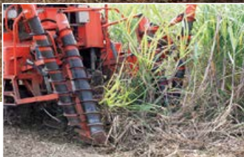
収穫機前方のローラーでさとうきびを巻き取り、葉と根がカットされて30~40cmに断裁後、ネットに収納
