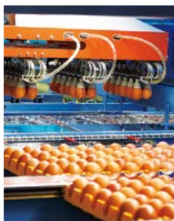
汚卵検査装置では流れてくる卵をリアルタイムにカメラでチェック
