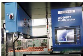
汚卵検査装置では流れてくる卵をリアルタイムにカメラでチェック
