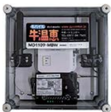
牛の体温変化から分娩兆候を検知する牛温恵の送受信機器
