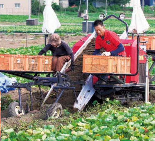
芋掘り機が畝を崩しながら掘り上げていく芋を2人で収穫籠に入れていきます
